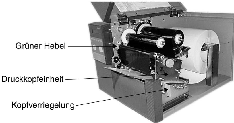
9. Stellen Sie mit dem Einstellrad an der Druckkopfeinheit den nötigen Druck für das gewählte Material ein. Für Medien mit einer Breite bis zu 60mm benutzen Sie Position „1“ (Minimum), für Medien mit einer Breite zwischen 60 und 120mm benutzen Sie Position „2“ und für für Medien mit einer Breite größer als 120mm benutzen Sie Position „3“ (Maximum).
