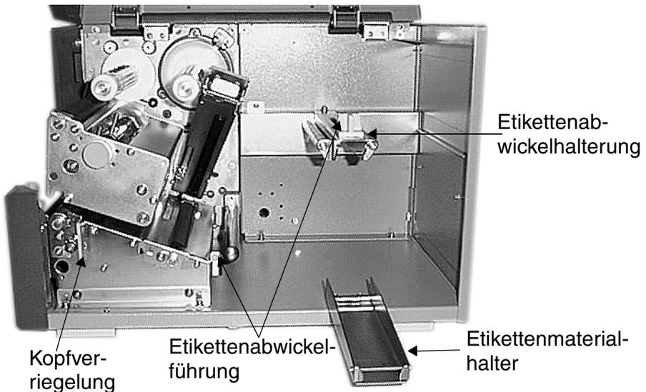
4. Schieben Sie die Etikettenmaterialrolle auf die Etikettenabwickelhalterung, wobei die zu bedruckende Seite der Etiketten beim Abwickeln von der Rolle nach oben zeigt. Schieben Sie die Rolle ganz nach innen und die Etikettenabwickelführung so weit nach innen, dass diese direkt außen an der Etikettenmaterialrolle anliegt.
