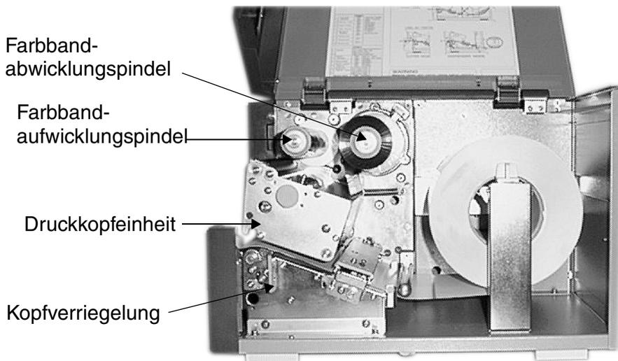
4. Schieben Sie den Farbbandwickelkern so weit nach innen auf die Farbbandaufwicklungsspindel, dass dieser direkt am Ende der Spindel anliegt. Bitte beachten Sie, dass jeweils der leere Wickelkern einer Rolle als Aufwickelkern für die nächste Farbbandrolle dient.
