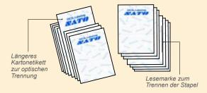
Der Drucker kann einzelne Stapelteile separieren, indem er entweder das erste Etikett der Reihe größer als die anderen ausgibt oder auf das erste Etikett der Reihe eine Lesemarke aufträgt.
